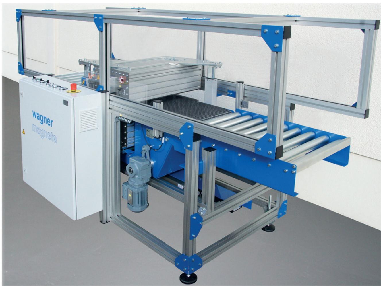
Wenn Stahl- und Gussteile in ein Magnetfeld gelangen, bleibt ein Restmagnetismus zurück. Für die weitere Bearbeitung ist es oft notwendig, solche Teile wieder ausreichend zu entmagnetisieren. Die Entmagnetisier-Anlage Typ 215 zeichnet sich durch ihre besonders stark entmagnetisierende Wirkung aus. Sie kommt zum Einsatz, wenn eine vollständige Entmagnetisierung der Teile erforderlich ist, wie z. B. bei Mess- und Schnittwerkzeugen oder bei Fräsern.
