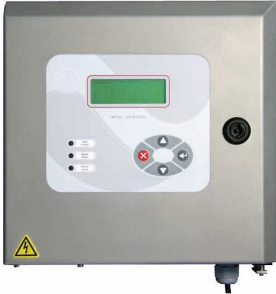
Die Steuerelektronik 650/2 besitzt ein eigenes, abschirmendes Stahlblechgehäuse zur Wandmontage. Das Bediendisplay ist staub- und wasserdicht in die Fronttür integriert. Alle notwendigen elektrischen Anschlüsse können über die zahlreichen Verschraubungen der Unterseite ausgeführt werden.
